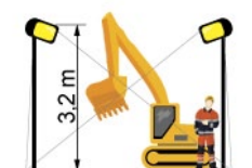
Rys. 8. Oświetlenie światłem sztucznym miejsca pracy maszyny
